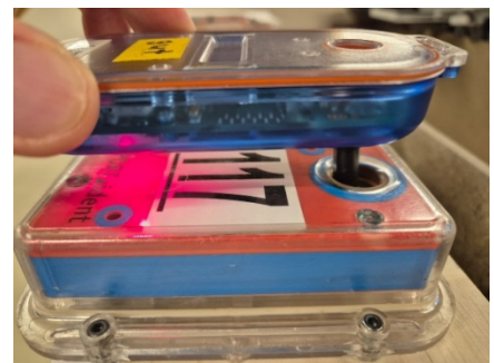
Bild 4: SI-Master mittels Koppelstift mit SI-Einheit verbinden
