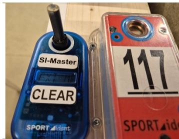
Bild 3: Koppelstift mit dicker Seite in SI- Master stecken
